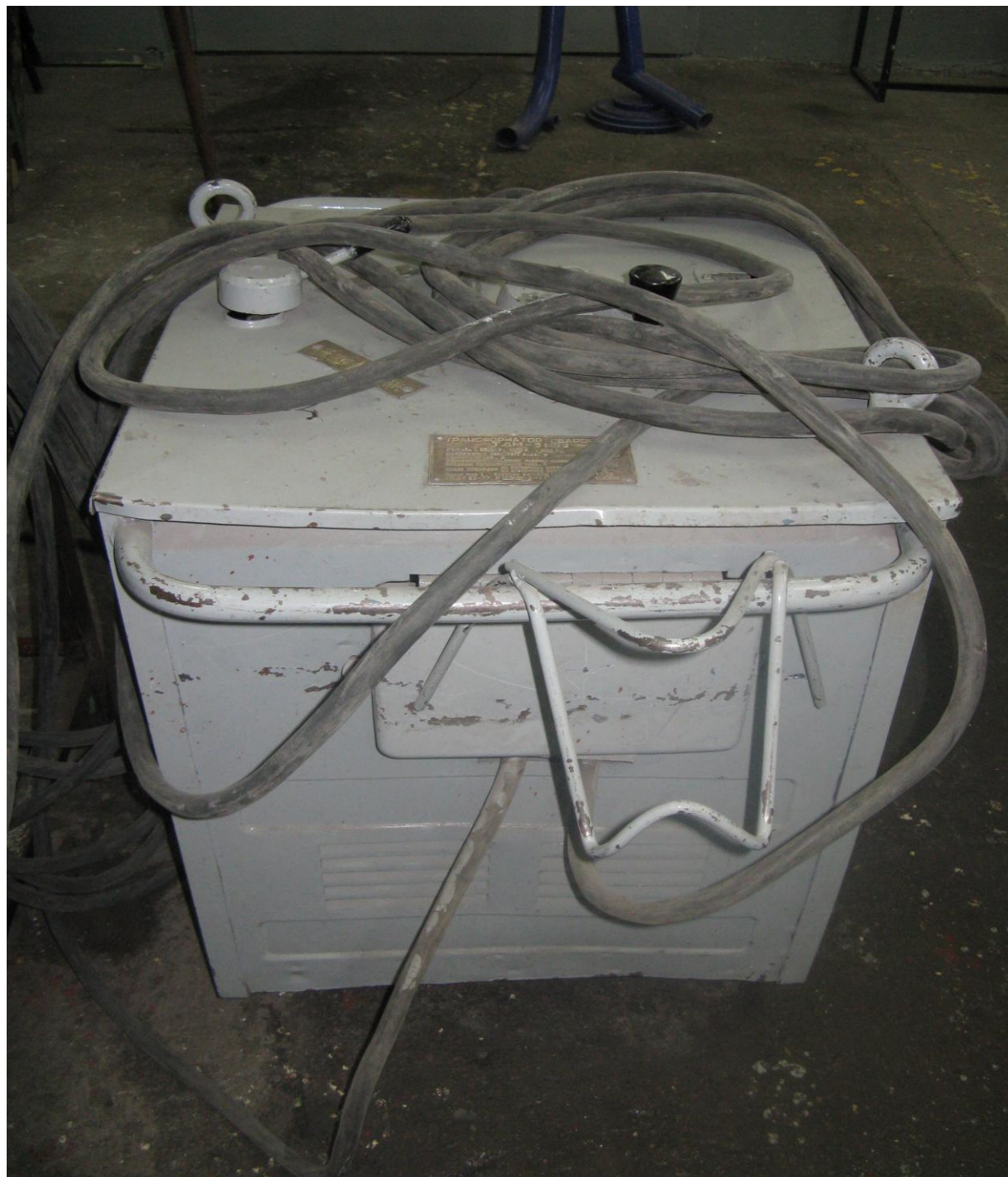
Zdjęcie nr 6 Transformator spawalniczy TDM 31U2
